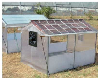
Serra prototipo con copertura in fotovoltaico organico semitrasparente
