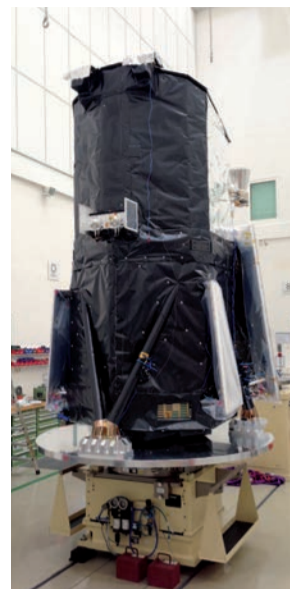
Il satellite eRosita, installato presso gli stabilimenti labg in Germania, montato su attrezzature Airworks per i test termo-strutturali
