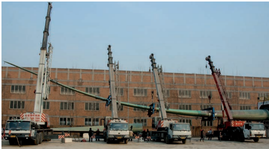
I test statici della pala eolica da 2 MW svolti in Cina presso il Baoding Huay Wind Turbine Blade Research Center
